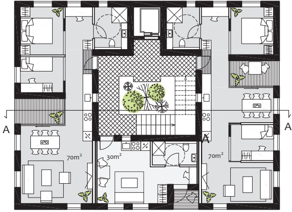
Hústýpa C - Grunnmynd 2.hæðar 1:200
